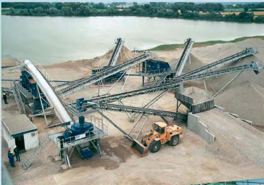
**Impianto di lavorazione di inerti alluvionali nella Regione dell' Alto Reno per la produzione di aggregati poliedrici.**
