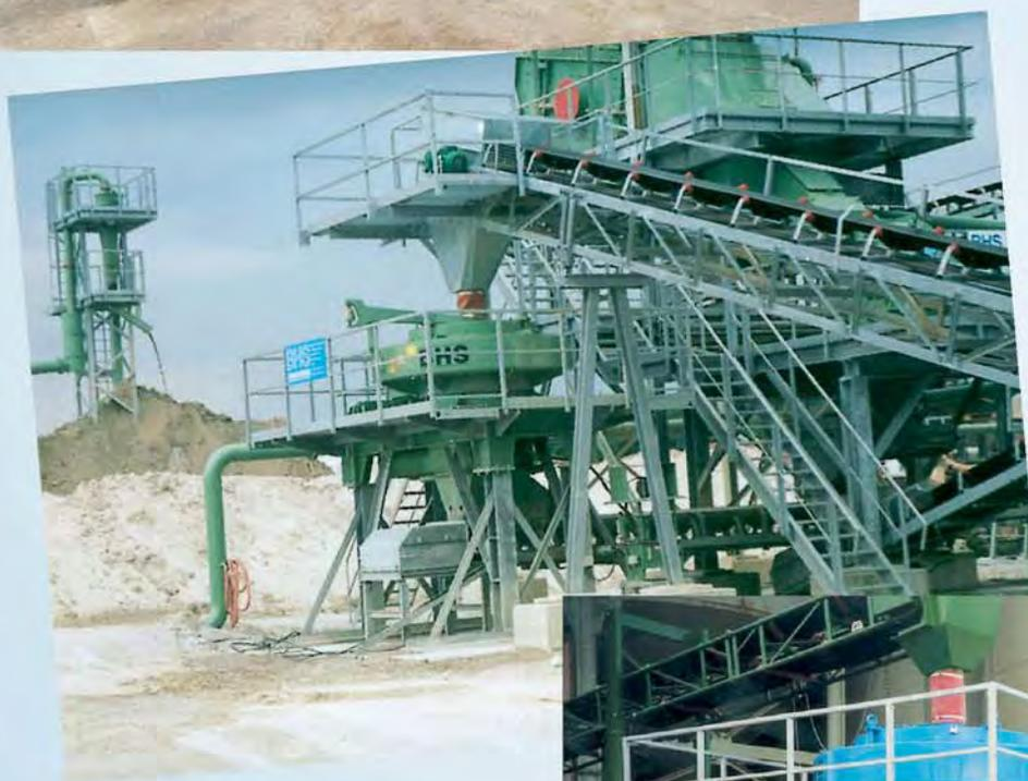
**Impianto per la disgregazione e la riqualificazione di rocce agglomerate per l'ottenimento di prodotti commerciabili di alta qualità.**
